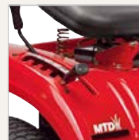
NASTAVENIE VÝŠKY KOŠENIA & SPOJKA ŽACIEHO ÚSTROJENSTVA
